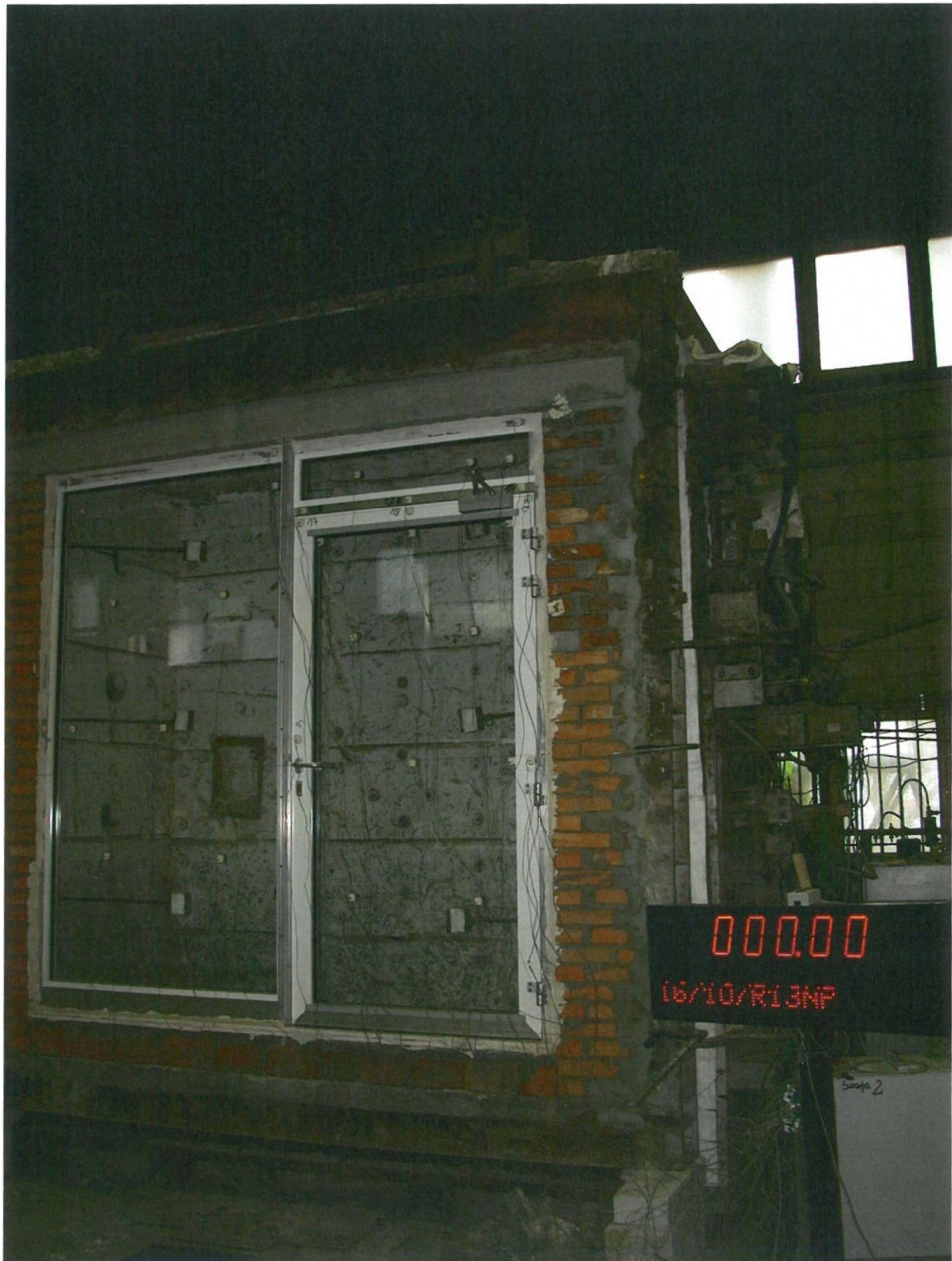
Foto. 2. Ansicht der nicht erhitzten Oberfläche der Prüfkörper vor der Prüfung
