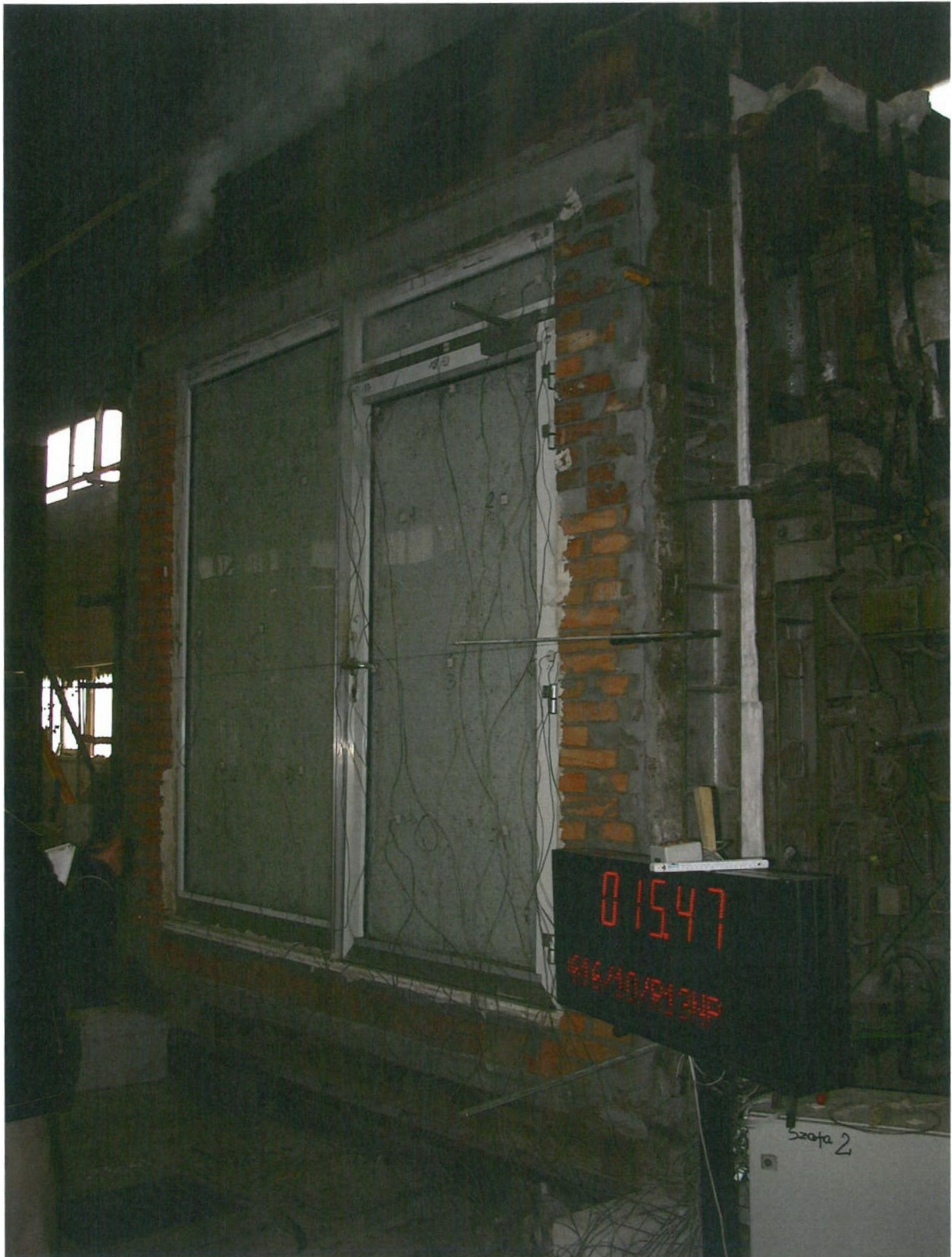
Foto 6. Ansicht der unbeheizten Oberfläche des Prüfkörpers in der 16. Minute der Prüfung
