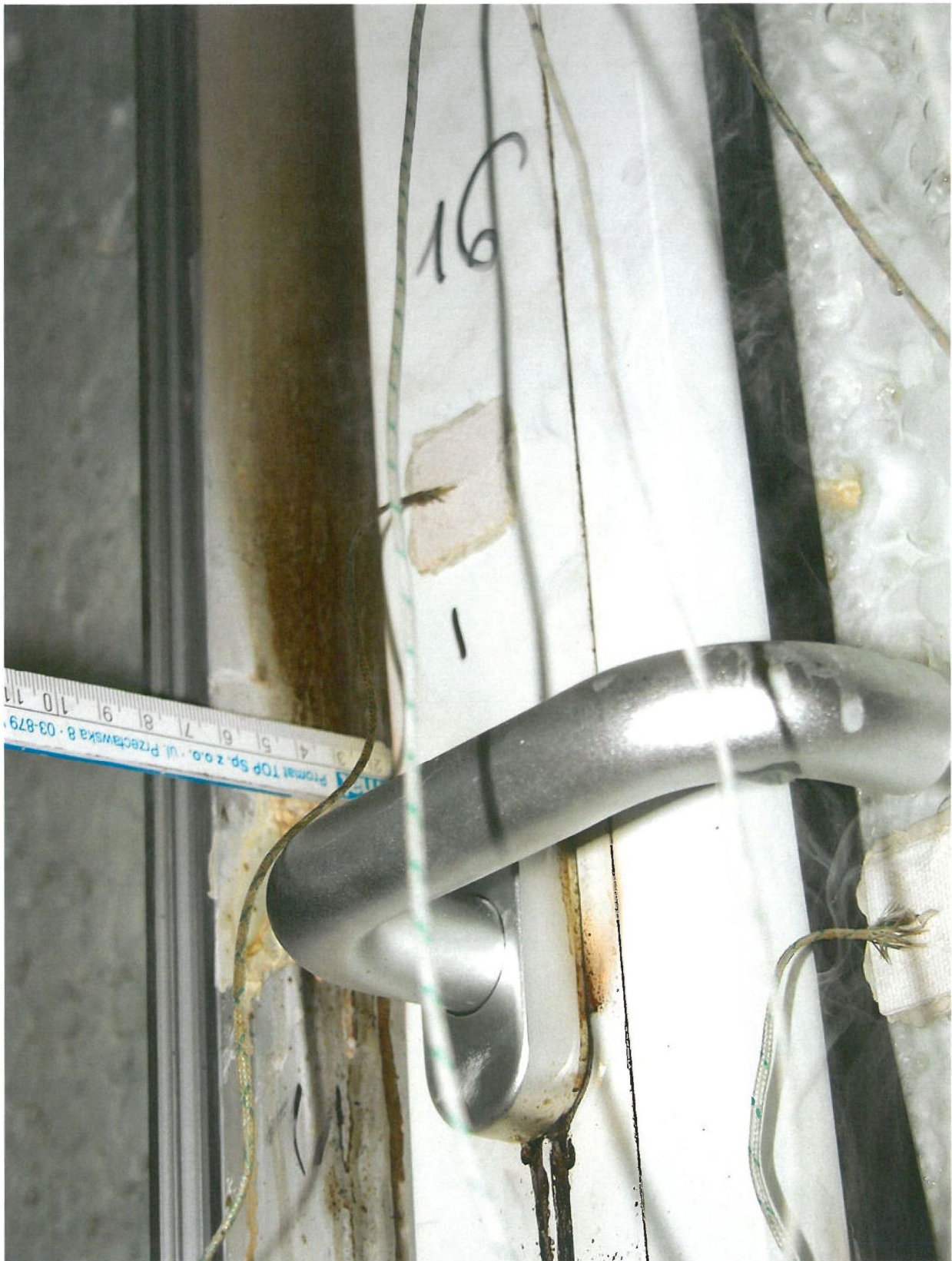
Foto. 8. Ansicht der unbeheizten Oberfläche des Prüfkörpers in der 32. Minute der Prüfung (Detail)
