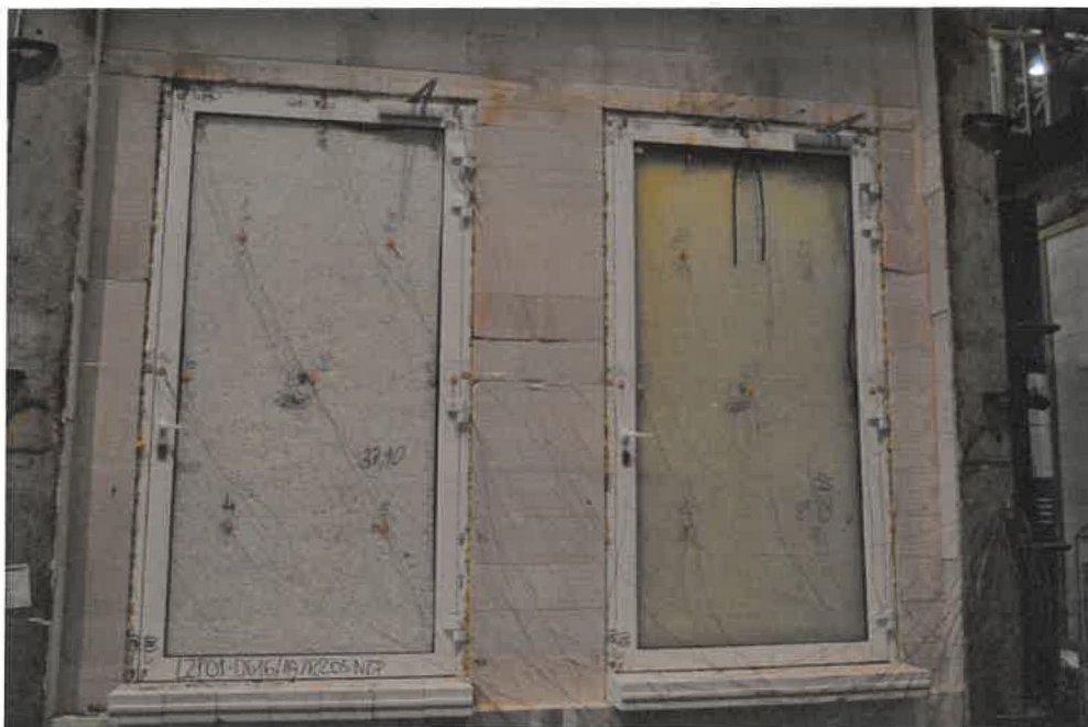
Foto 8 Ansicht der nicht erhitzten Oberfläche der Prüfkörper nach der Prüfung
