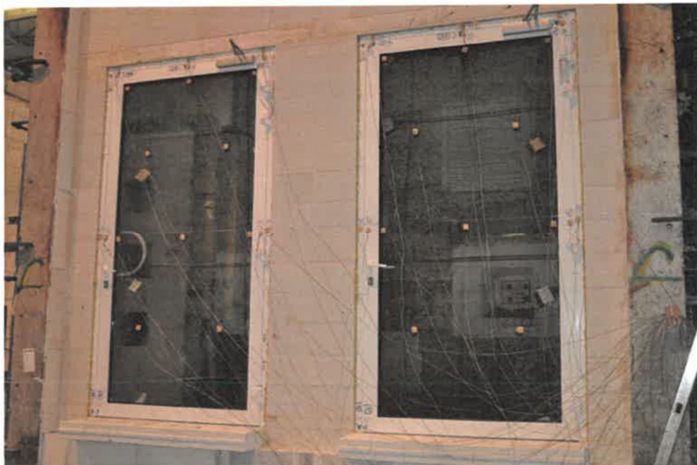
Foto 2. Ansicht der nicht erhitzten Oberfläche der Prüfkörper vor der Prüfung
