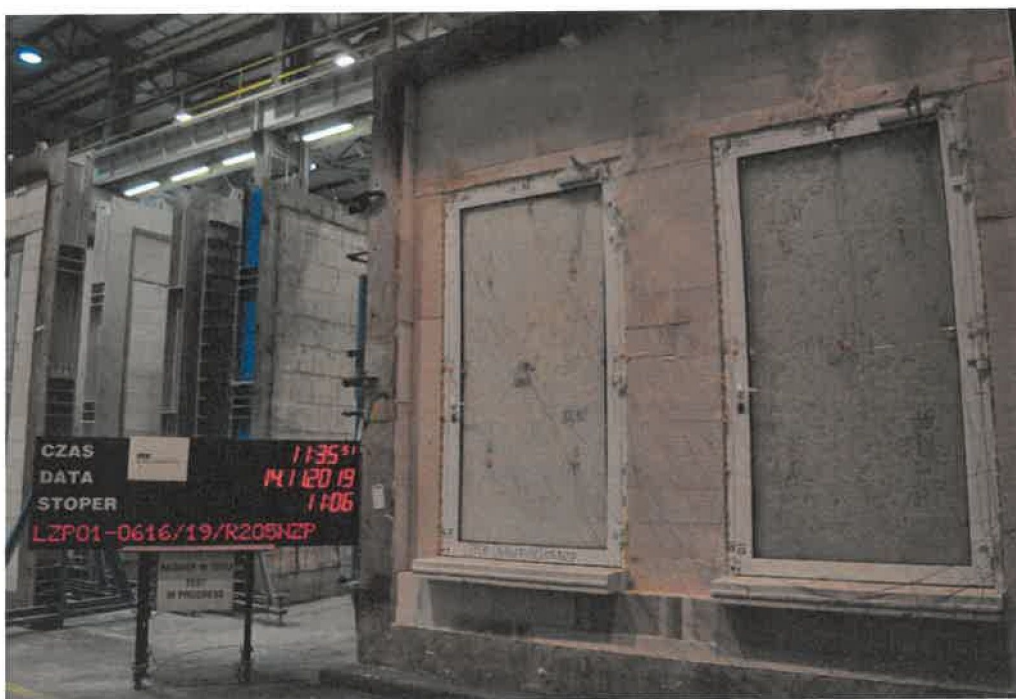
Foto 6. Ansicht der unbeheizten Oberfläche der Prüfkörper in der 12. Minute der Prüfung
