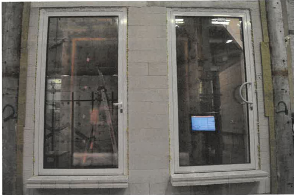
Foto 1. Ansicht der erhitzten Oberfläche der Prüfkörper vor der Prüfung
