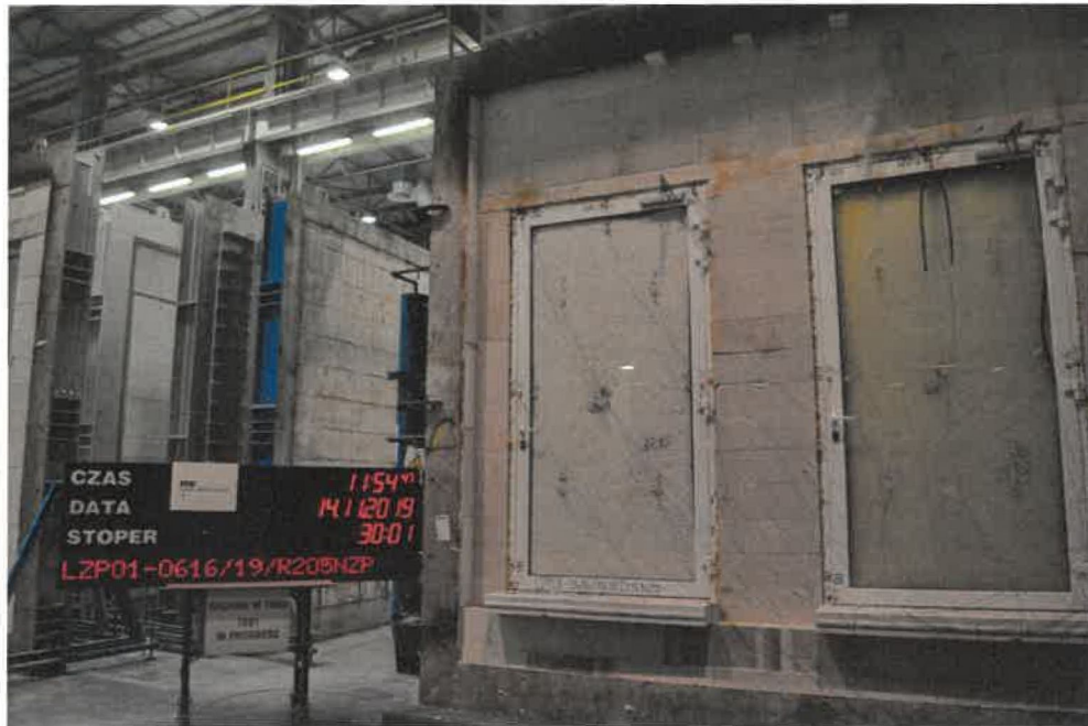
Foto 7. Ansicht der unbeheizten Oberfläche der Prüfkörper in der 31. Minute der Prüfung
